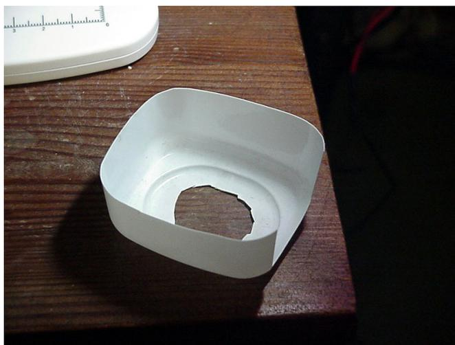
Il nome tecnico che si usa in Fotografia per un simile accessorio è “gabbia di luce” ed il suo scopo è quello di diffondere in modo uniforme la luce al suo interno.
